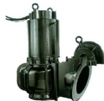
可拆式潜水泵 (灰铁材质) 口径200mm 12kW左右 550kg左右
